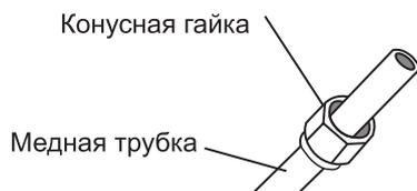
4. Снимите ленту ПВХ с концов трубы для проведения вальцовки.
