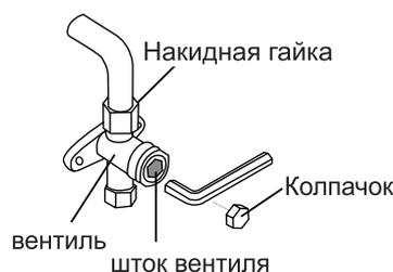
12. С помощью шестигранного ключа полностью откройте вентили высокого и низкого давления.
